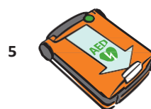
5 Ujistěte se, že indikátor Rescue Ready svítí zeleně
