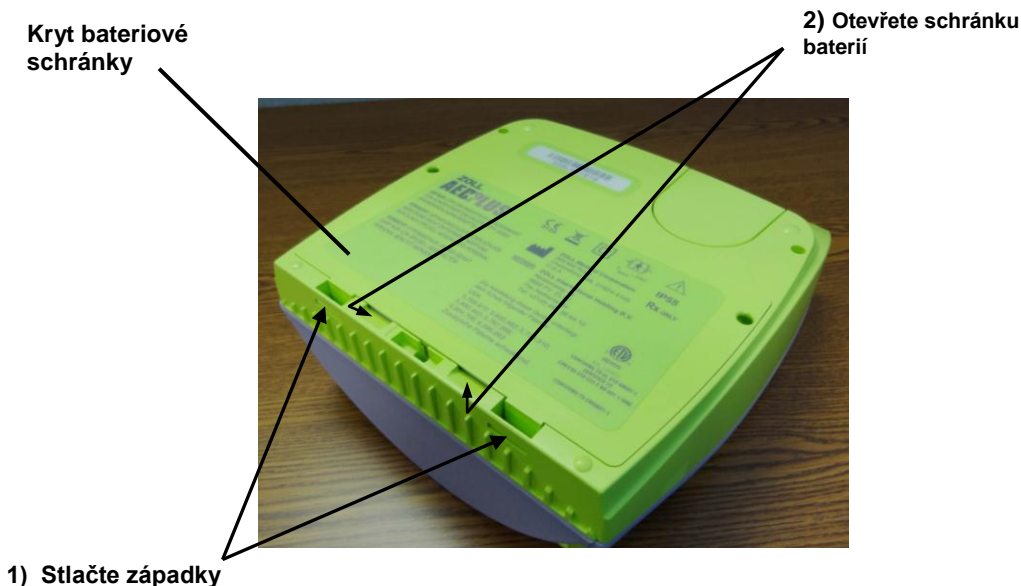
Obr.7.: Odstraňování dvířek bateriové přihrádky
