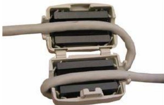
Obr. 5.6 Instalace kabelu do feritového jádra
